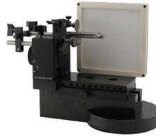
6" × 6" LED面板背景灯是获取刀具轮廓图像的理想光源配件。在刀具背面放置光源,可以让刀具的轮廓非常清晰。光源亮度可以在REACTION软件中控制。与REACTION软件中的实况和检测功能一起使用时,可以调用已保存的照明参数来进行刀具的重复检测。背景灯组件包含一个连接在基座上的可调节支架,以方便定位。
