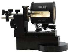
八象限LED照明管为高精度刀具检测提供了一个可控制的光源环境。照明管高定制的光源控制对于高放大倍率的小刀具检测非常有效。每个象限的光源亮度都可以通过REACTION软件单独控制。
